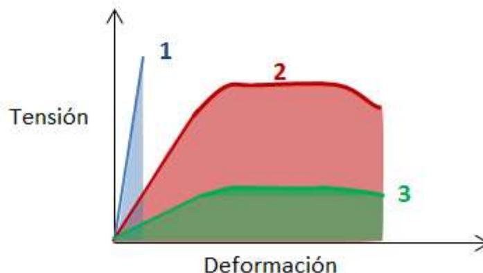
**Rigidez:** Es la relación que existe entre la tensión aplicada y la deformación que esta produce en régimen elástico. Un material muy rígido es aquel que para tensiones altas presenta deformaciones bajas. Es la pendiente de la curva tensión-deformación:
