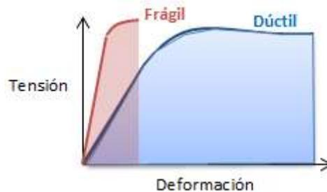
Resiliencia: Es la energía que es necesaria aplicar un unidad de volumen de un cuerpo para deformarla hasta su límite elástico. En el ejemplo de una probeta a compresión es el área bajo la curva tensión-deformación hasta el límite elástico. Se mide en Julios/m<sup>3</sup>. Un material resiliente tiene el límite elástico muy alto y el modulo elástico muy bajo. Un ejemplo de esto son los muelles.
